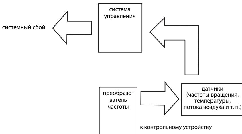
Кроме того, контроль частоты вращения дает возможность сравнивать частоту, заданную преобразователю, с фактической частотой вращения, и реагировать в случае ее отклонения.
