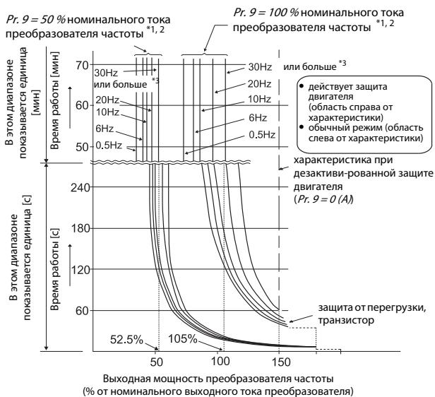
Функция защиты электродвигателя определяет частоту и ток электродвигателя. В зависимости от обоих этих факторов и номинального тока электродвигателя, при перегрузке электронное устройство защиты активирует защитные функции.
