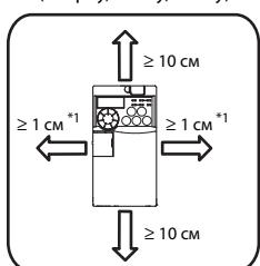
\*1 Преобразователи, эксплуатируемые при температуре окружающего воздуха не более  $40^{\circ}\text{C}$ , можно установить без бокового промежутка (непосредственно рядом друг с другом). Если, однако, температура окружающего воздуха превышает  $40^{\circ}\text{C}$ , должно быть выдержано минимальное боковое расстояние 1 см (или 5 см в случае преобразователей FR-E740-120 и выше)
