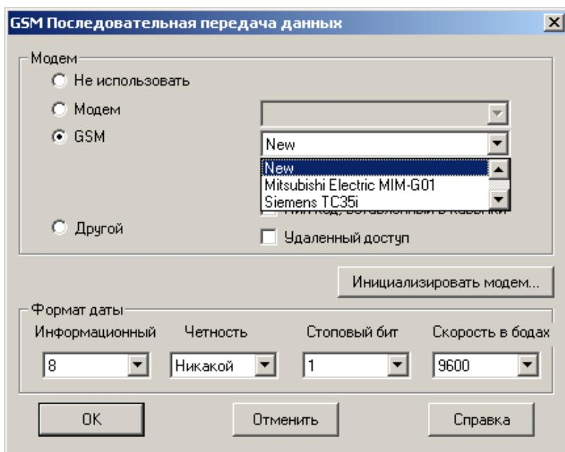
При выборе одного из перечисленных модемов, AT-команда будет автоматически введена в строку инициализации модема. Рамкой на рисунке выше обведен список предварительно сконфигурированных GSM модемов. Опции для модемов GSM указаны ниже.
