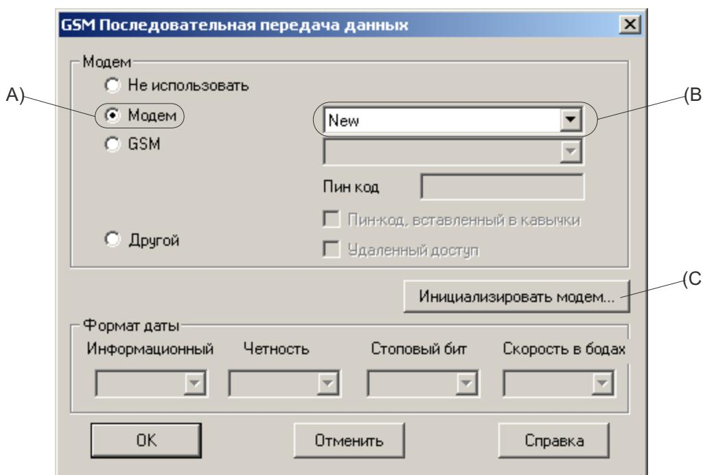
**A) Модем** – Этот пункт используется при подключении стандартного модема к ALPHA2 для использования удаленного доступа.
