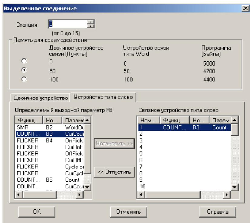
Для установки связи с устройством типа слово, выберите номер в списке “Связное устройство типа слова”, затем выделите функциональный блок в окне “Определяемый выходной параметр FB”. Чтобы задать соответствие функционального блока адресу передачи данных, нажмите кнопку “Установить”.
