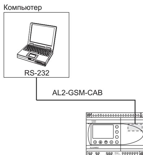
Контроллер серии ALPHA2 (AL2-14MR-\*, AL2-24MR-\*) версии 1.00 оборудован интерфейсом RS-232C. Таким образом, можно установить связь 1:1. Номера станции расположены в диапазоне 00-0F (16-ричн.).
