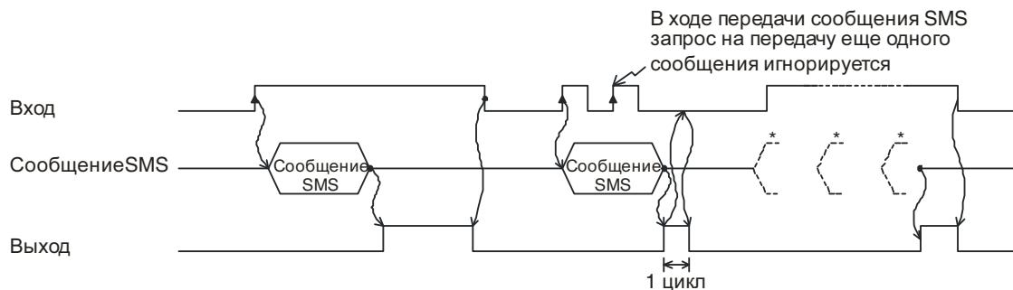
Пример программы VLS для функционального блока SMS
