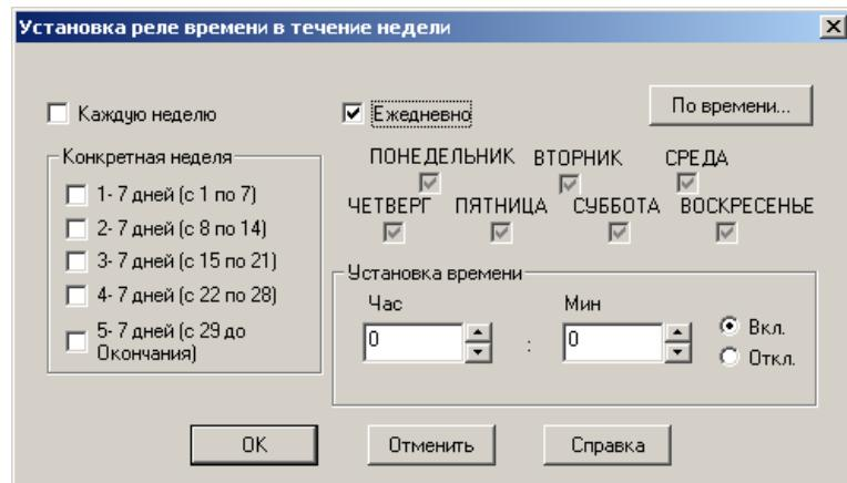
В этом примере, срабатывание реле времени будет установлено на определенную дату. В диалоговом окне справа можно установить ежемесячное, ежегодное срабатывание реле, или срабатывание по дате.
