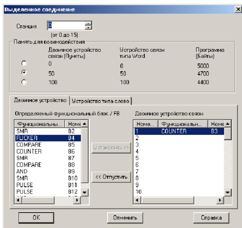
Для установки связи с двоичным устройством, выберите номер в списке "Двоичное устройство связи", затем выделите функциональный блок в окне "Определяемый функциональный блок". Чтобы задать соответствие функционального блока адресу передачи данных, нажмите кнопку "Установить".
