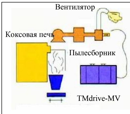
Применение эксгаустеров в производстве стали
