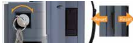
Выключатель с ключом и кнопка бдительности в рукоятке - для безопасной работы
